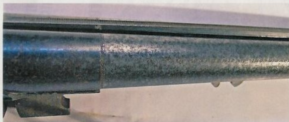
↑ Il trattamento preliminare delle canne con acido fosforico toglie la ruggine e prepara le superfici alla successiva lucidatura.
